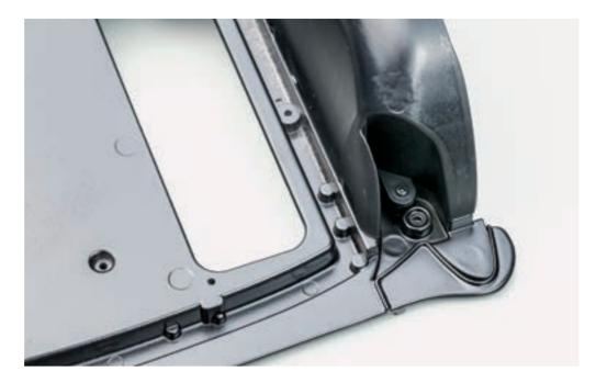
Совместите крепежные элементы деталей и зафиксируйте брызговик при помощи двух винтов 2,0×4 (ВМ). Во избежание поломки крепежных проушин брызговиков не рекомендуется прилагать излишние усилия при затягивании винтов.
